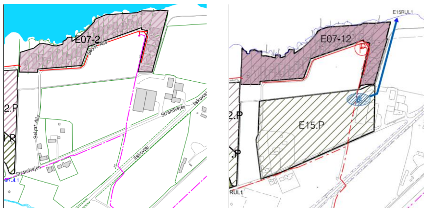
Figur 6. Nuværende spildevandsplan til venstre og kommende spildevandsplan med nyt bassin og nyt opland E15.P til højre.
